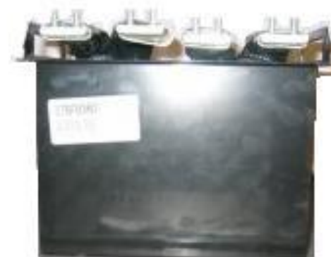
DC-дроссель (Входной фильтр)
